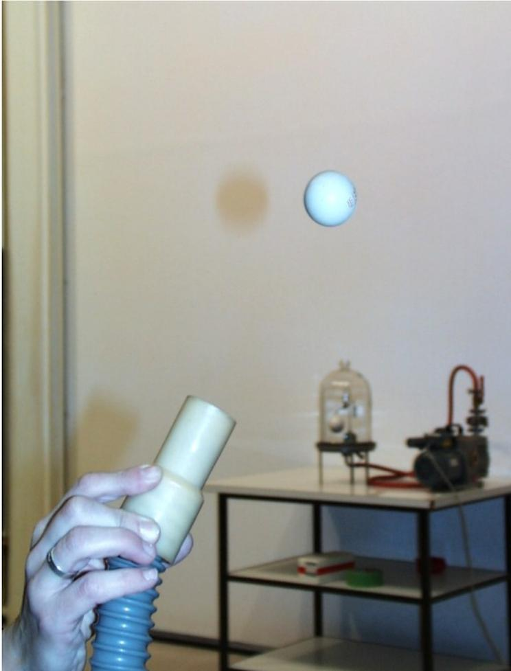
Der Luftstrom hält den Ball. Wenn er absinkt, strömt mehr Luft über den Ball, so dass hier der Druck abnimmt.
