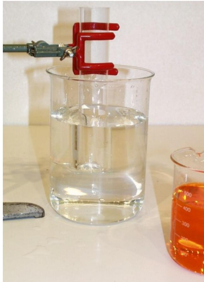
Der Wasserdruck preßt die Scheibe an das Rohr und verhindert das Eindringen des Wassers.
