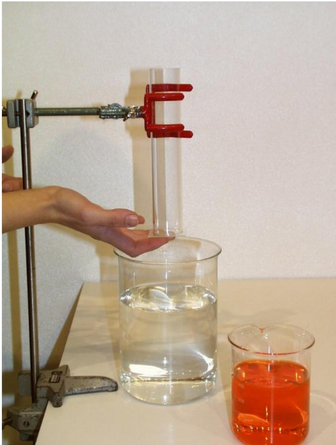
Eine Glasscheibe wird unten an das offene Glasrohr gedrückt. Dann taucht man das ganze in das Wasser.
