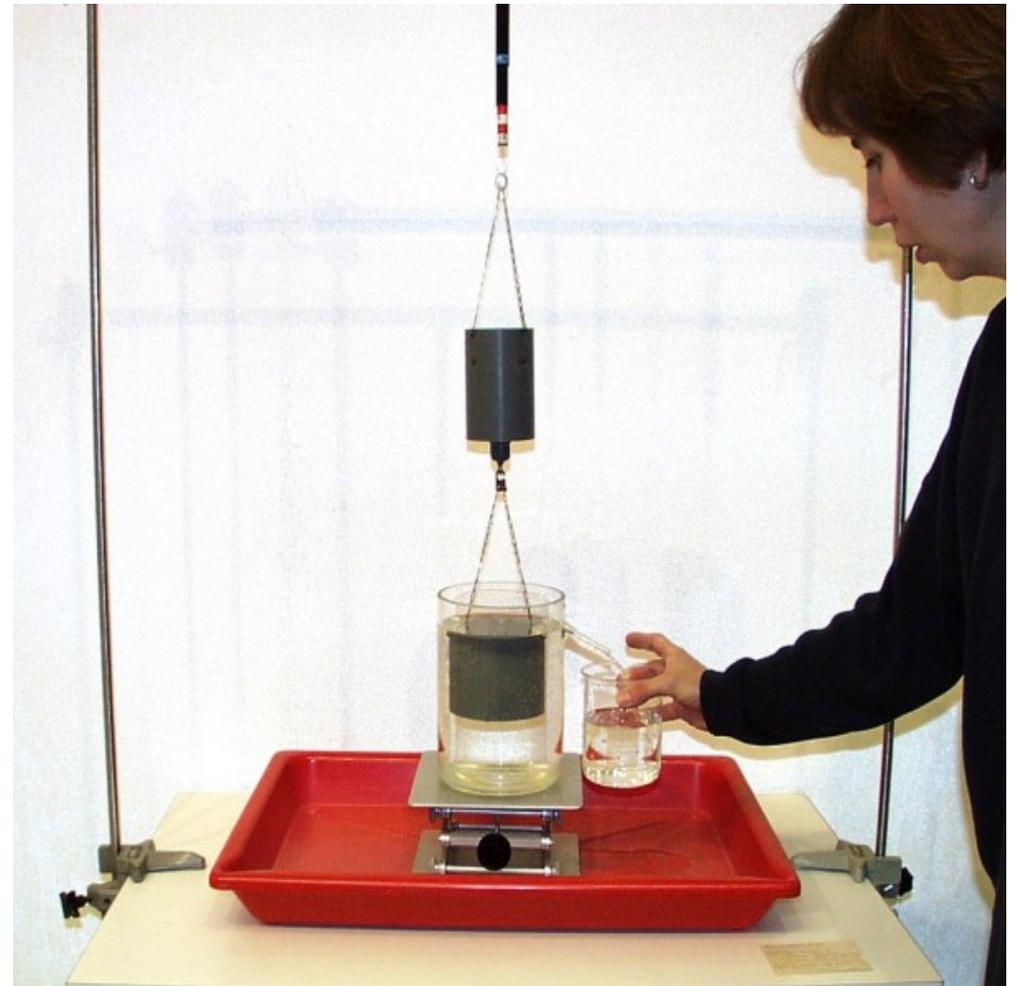
Der Körper wird in das Wasser getaucht. Die verdrängte Wassermenge läuft in einen Glasbehälter (siehe rechts). Die Federwaage zeigt wegen des Auftriebs ein geringeres Gewicht an.
