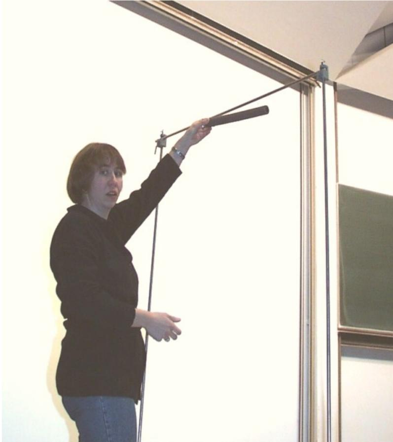
Um einen leichten runden Körper werden zwei Fäden gewickelt, an denen er hängt. Lässt man ihn los, wickeln sich die Fäden ab, und der Körper bewegt sich rotierend nach unten. Dabei entsteht eine ungleiche Druckverteilung.
