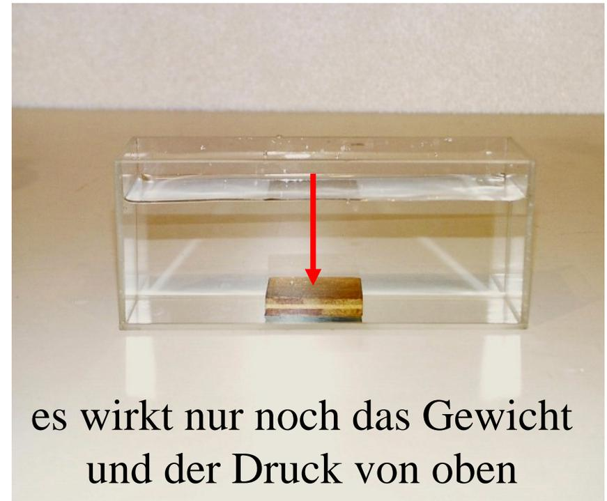
Der an der unteren Fläche mit einer dünnen, glatten Glasscheibe versehene Holzklotz schwimmt im Wasser. Wenn man den Holzklotz so auf den Boden drückt, daß die Glasscheibe mit der glatten Bodenfläche des Gefäßes eng in Berührung kommt, wird dadurch das Wasser verdrängt und die Auftriebskraft verschwindet. Der Holzklotz bleibt am Boden liegen.
