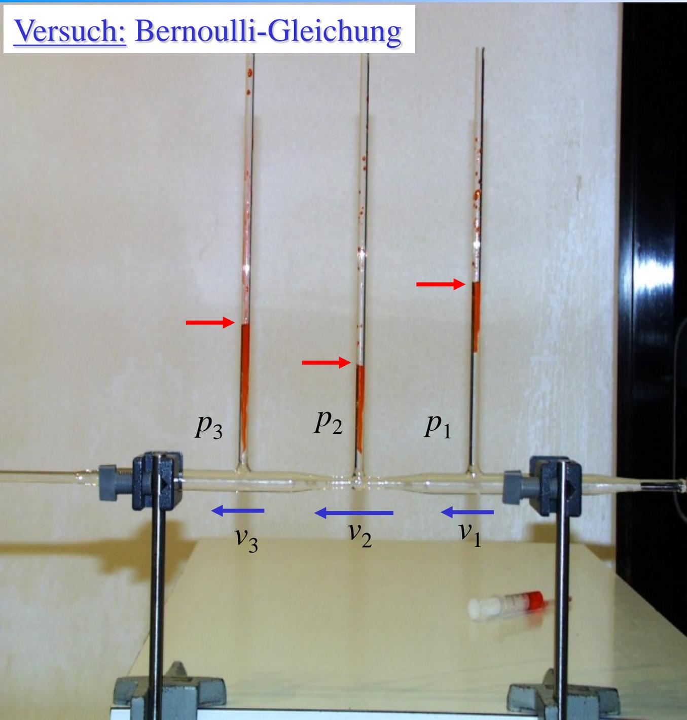
Die von Wasser durchströmte Glasröhre ist im mittleren Bereich deutlich dünner. Daher gilt
