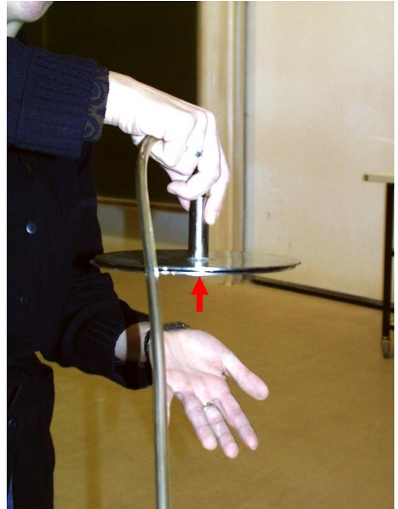
Aus der Mitte der Platte wird Luft geblasen. Hält man eine zweite Platte von unten dagegen, strömt die Luft zwischen ihnen aus und erzeugt dabei einen geringeren Druck. Der höhere Außendruck preßt die untere Platte gegen die obere, die dadurch gehalten wird.
