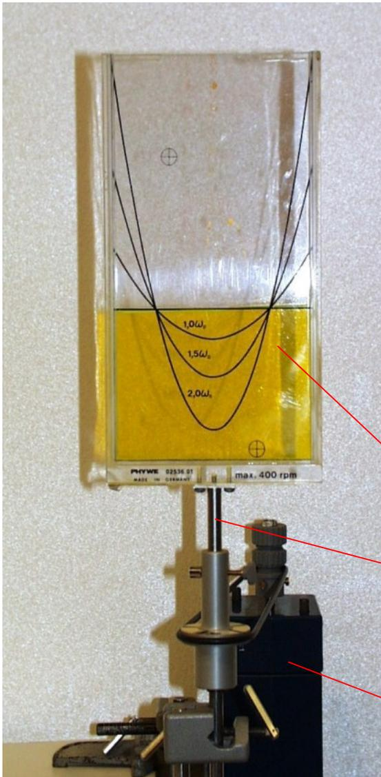
Bei ruhender Küvette ist der Wasserspiegel eben.
