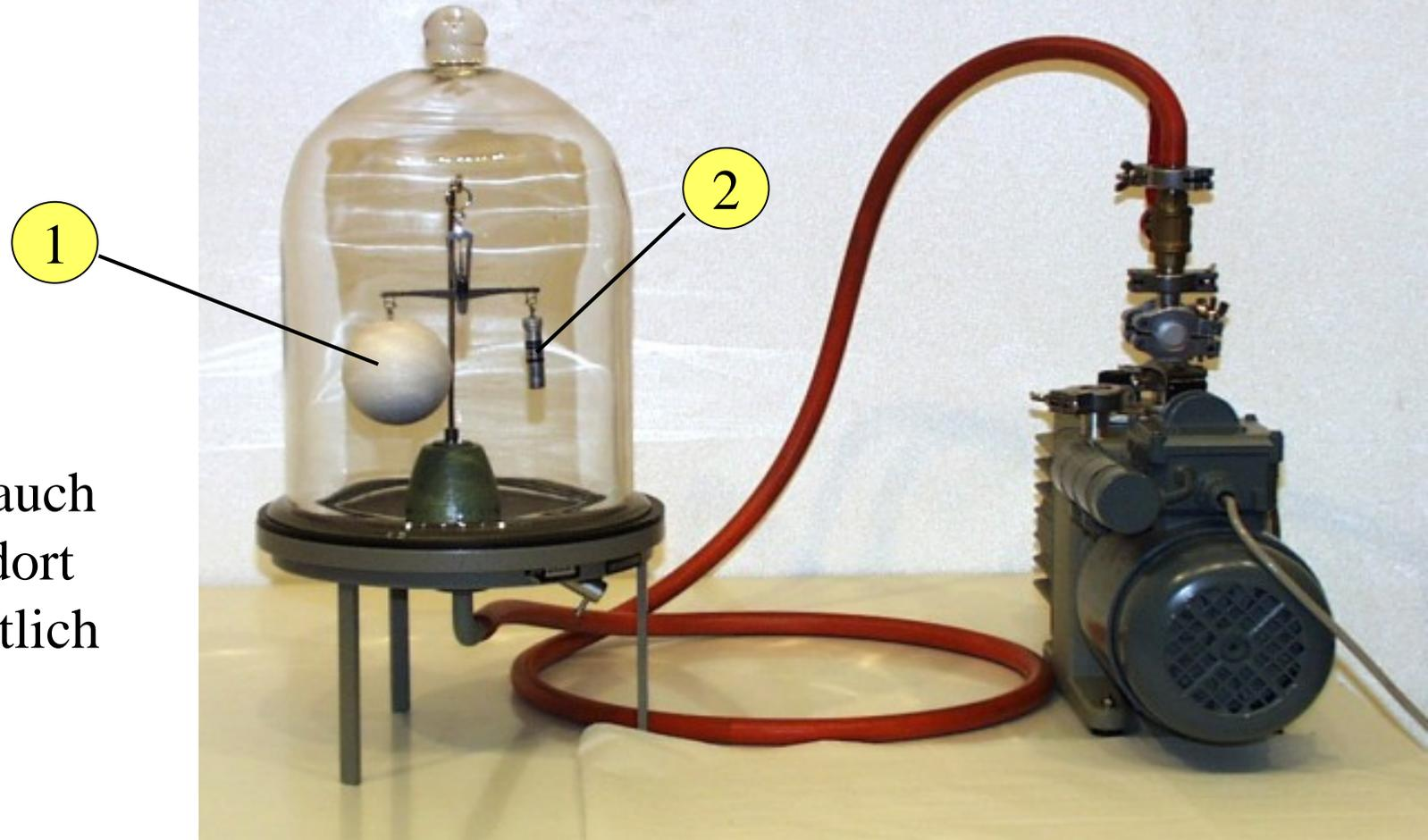
In Luft sind die große Styroporkugel (1) und der kleine Metallzylinder (2) im Gleichgewicht. Wegen des großen Volumens wirkt auf die Styroporkugel eine größere Auftriebskraft. Das Kräftegleichgewicht ergibt:
