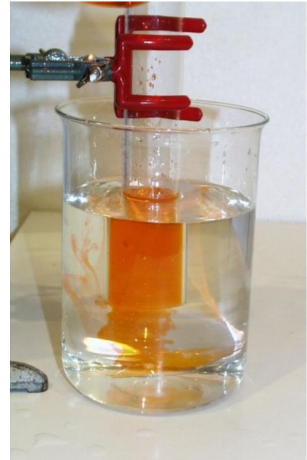
Wenn man von innen in das Rohr Wasser füllt (hier gefärbt), dann erhöht sich der Innendruck, bis die Scheibe fällt.
