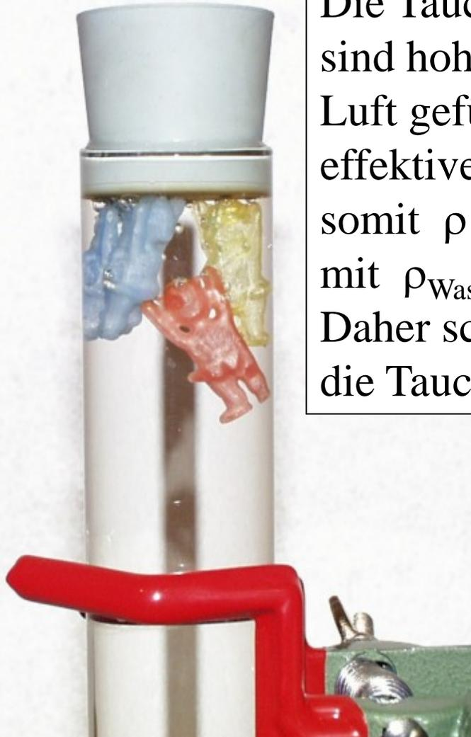
Die Taucherfiguren sind hohl und mit Luft gefüllt. Ihre effektive Dichte ist somit  $\rho < \rho_{\text{Wasser}}$  mit  $\rho_{\text{Wasser}} = 1 \text{ g/cm}^3$ . Daher schwimmen die Taucher.
