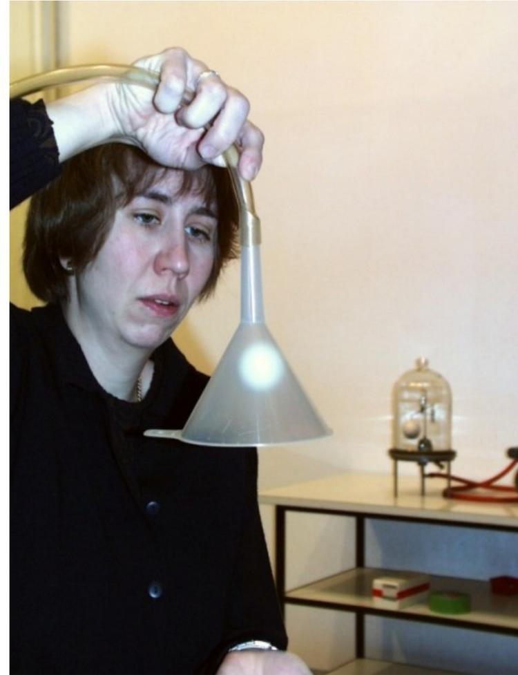
Der Ball im wird durch die strömende Luft nicht herausgeblasen, sondern im Trichter gehalten.
