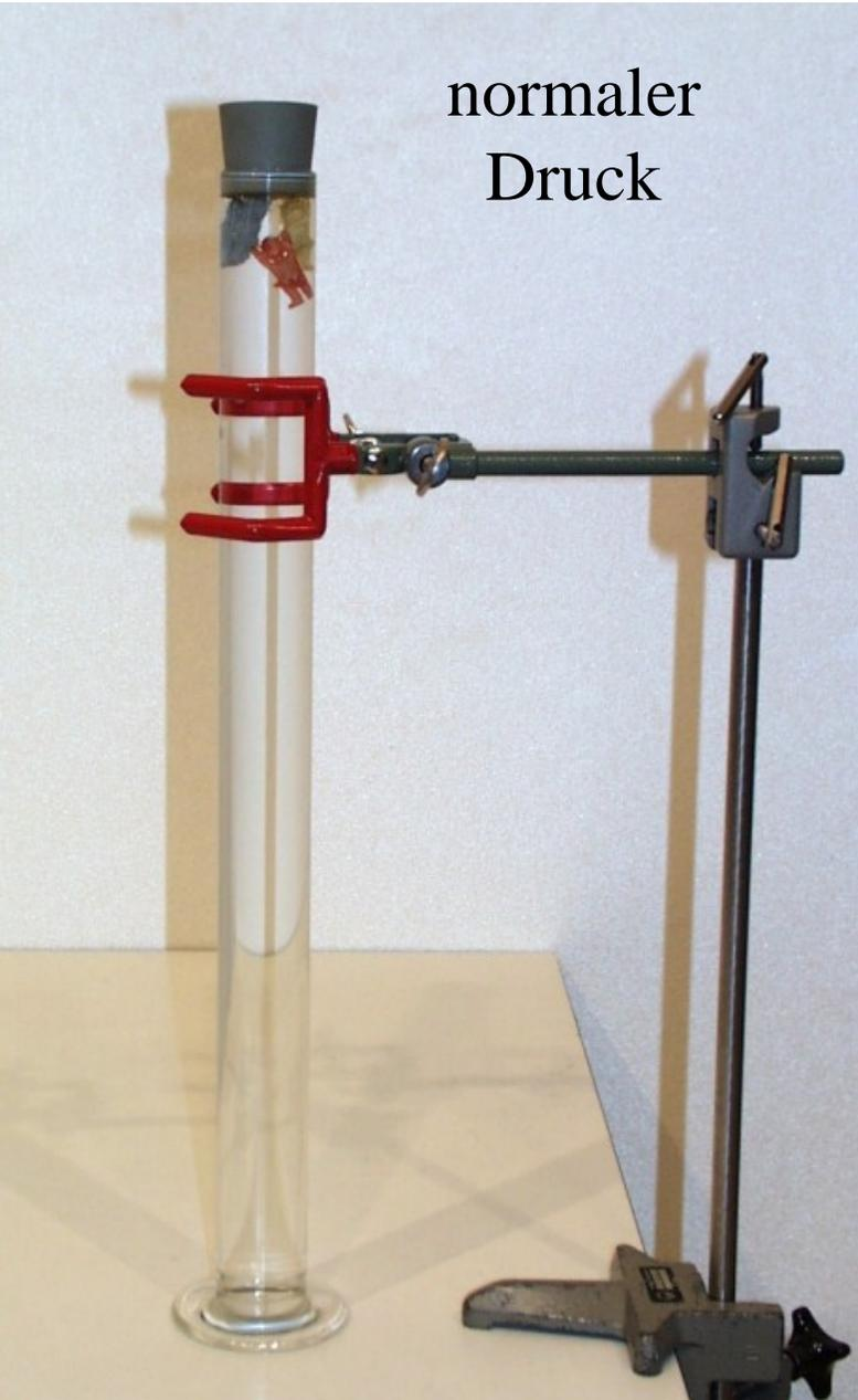
Erhöht man den Druck auf die Wassersäule, dringt Wasser durch das Loch in die Taucherfigur, bis die effektive Dichte auf  $\rho > 1 \text{ g/cm}^3$  steigt. Der Taucher sinkt.
