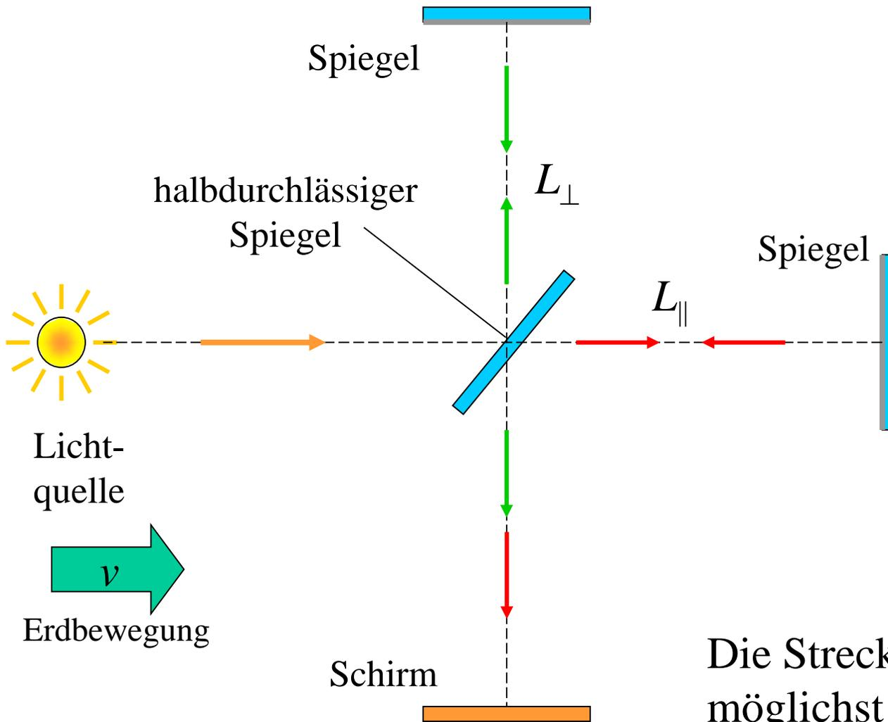
Der Lichtstrahl wird vom halbdurchlässigen Spiegel in zwei senkrecht zueinander verlaufende Strahlen aufgespalten, die nach Reflexion an den beiden Spiegeln wieder überlagert werden.
