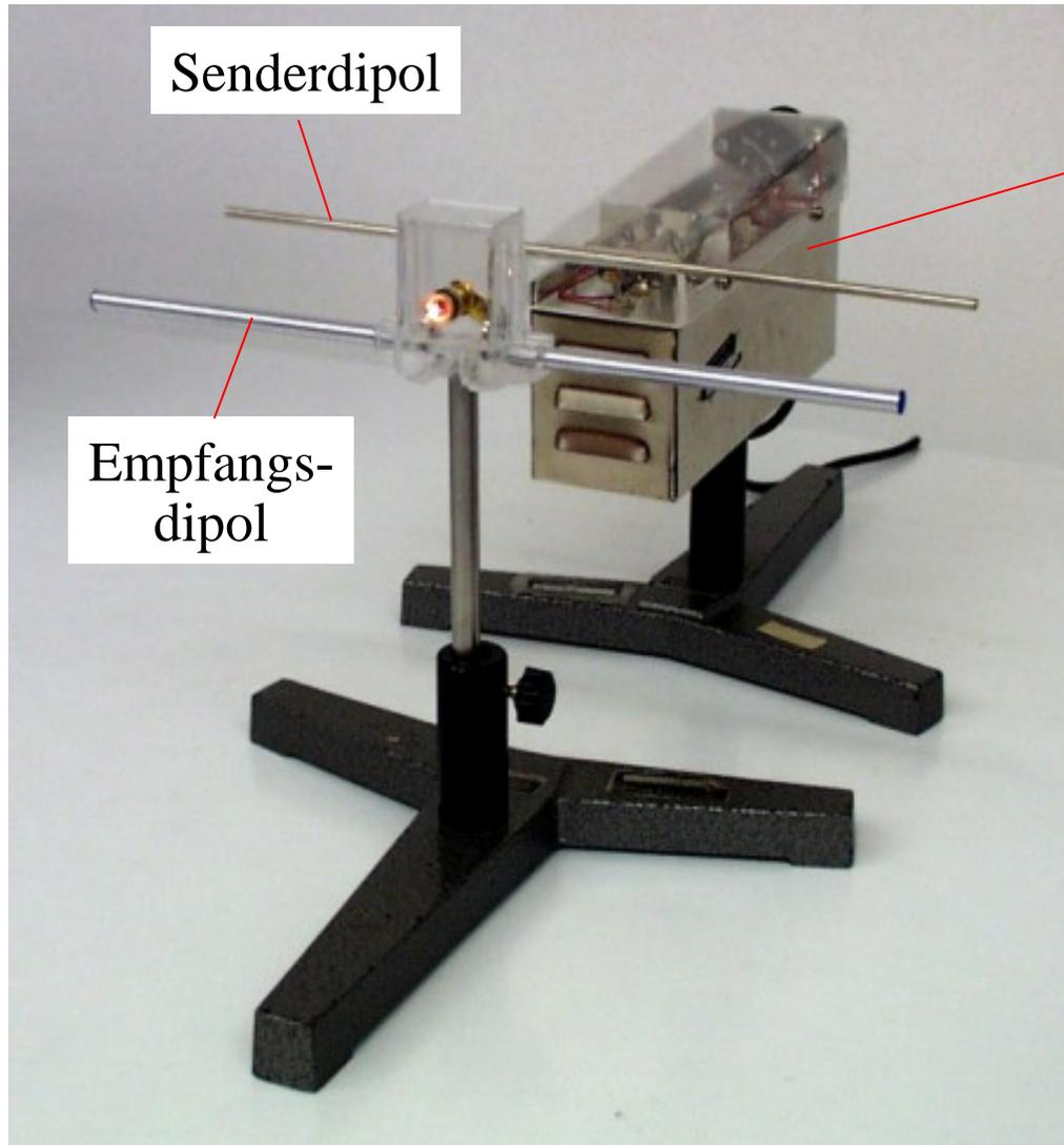
HF-Generator mit Röhrenverstärker
