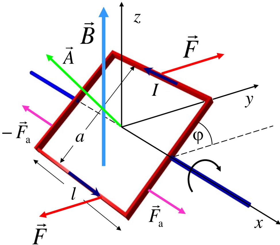
Eine von einem Strom  $I$  durchflossene rechteckige Leiterschleife mit den Kantenlängen  $a$  und  $l$  befindet sich um die  $x$ -Achse drehbar in einem homogenen Magnetfeld  $B$ .
