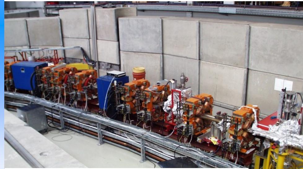
In Teilchenbeschleunigern wie DELTA werden daher Magnete zur Ablenkung verwendet!
