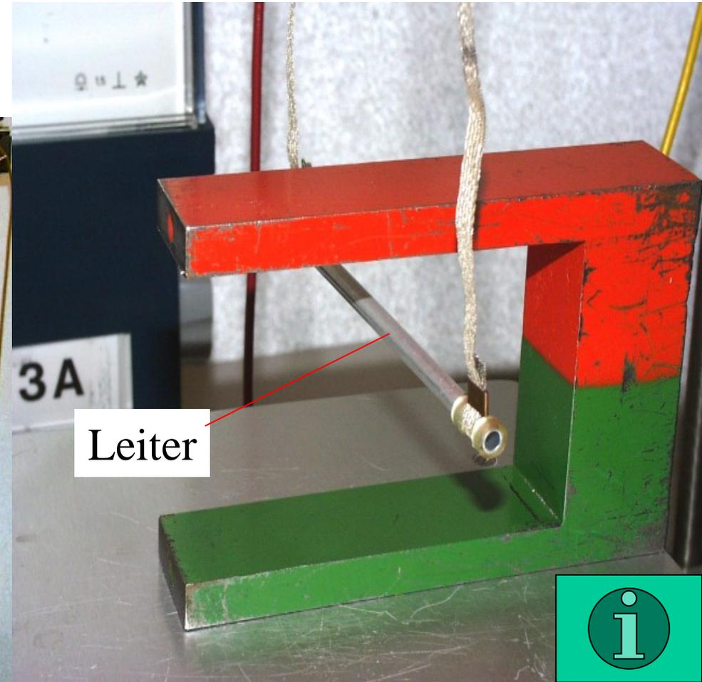
Der stromdurchflossene Leiter wird je nach Richtung des Stromflusses in den Magneten hineingezogen oder herausgedrückt.
