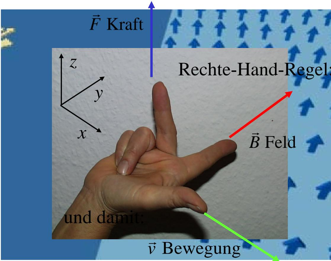
Eine Ladung  $q$  bewegt sich mit der Geschwindigkeit  $\vec{v}$  in einem magnetischen Feld  $\vec{B}$ .
