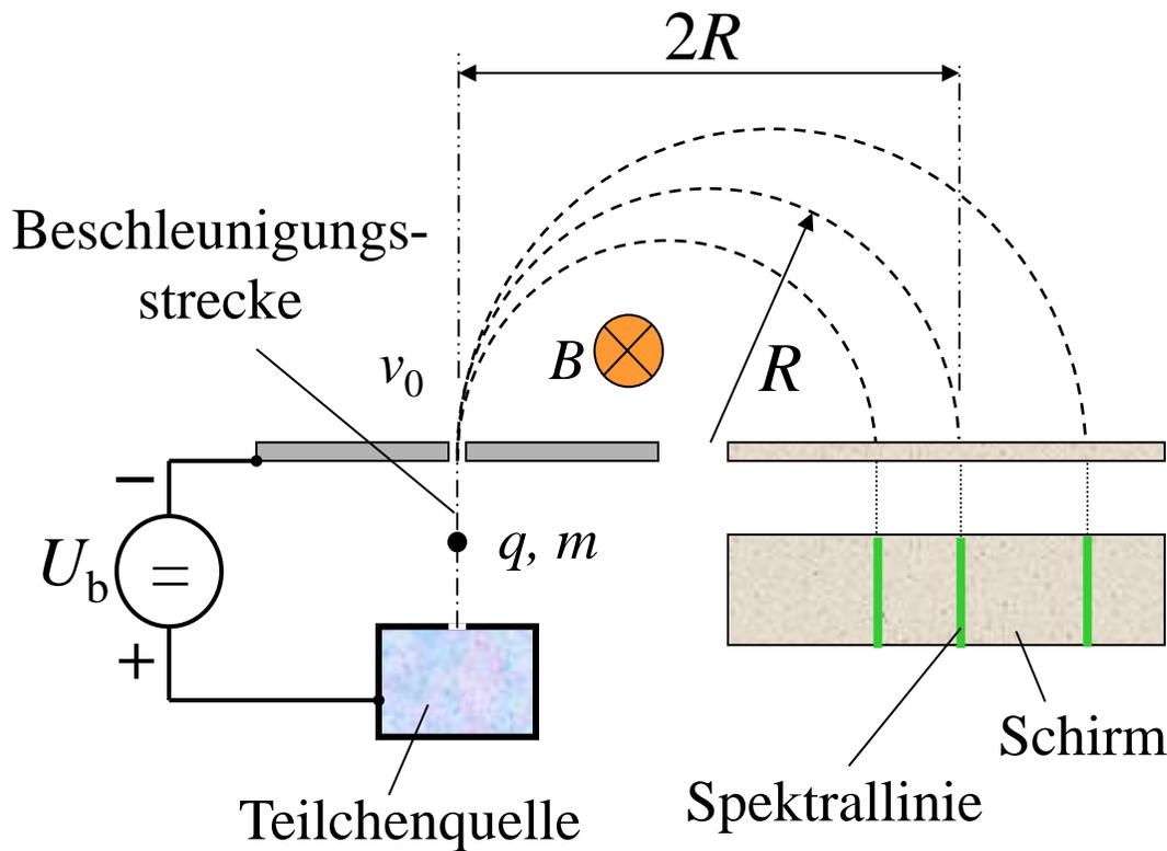
Die geladenen Teilchen werden durch  $U_b$  beschleunigt und erhalten die Geschwindigkeit:
