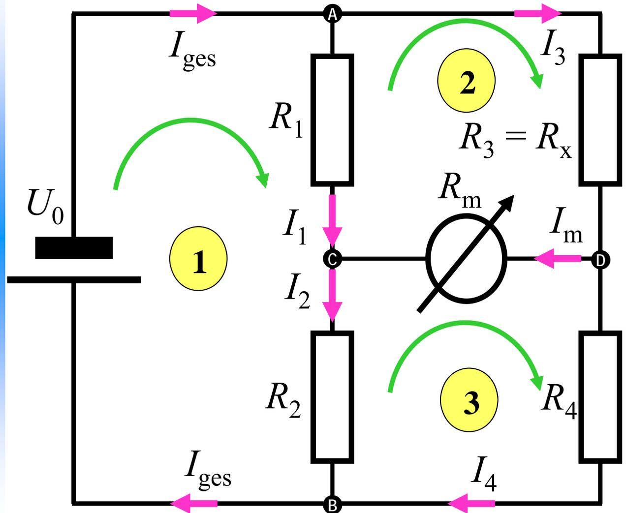
Wir nehmen an, daß  $R_3 = R_x$  unbekannt ist. Man soll  $R_1$  so variieren, daß  $I_m = 0$  wird (Kompensationsmethode zur Messung von Widerständen).
