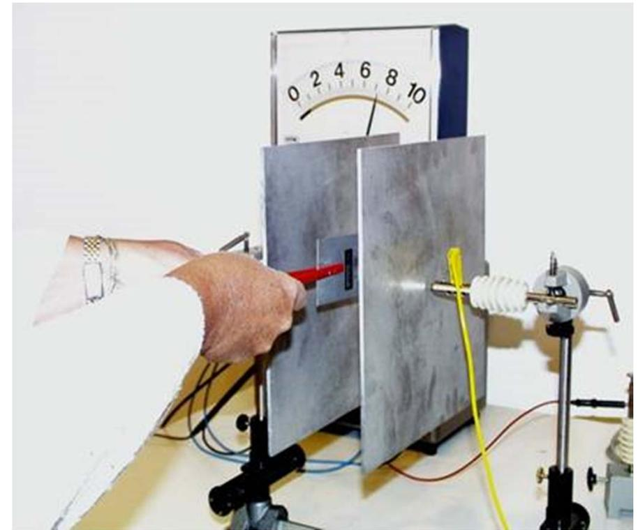
Die elektrisch neutralen Löffel werden zusammengedrückt in das elektrische Feld geführt. Dann werden sie getrennt und aus dem Feld genommen. Danach tragen sie jeweils eine Ladung mit unterschiedlichem Vorzeichen.
