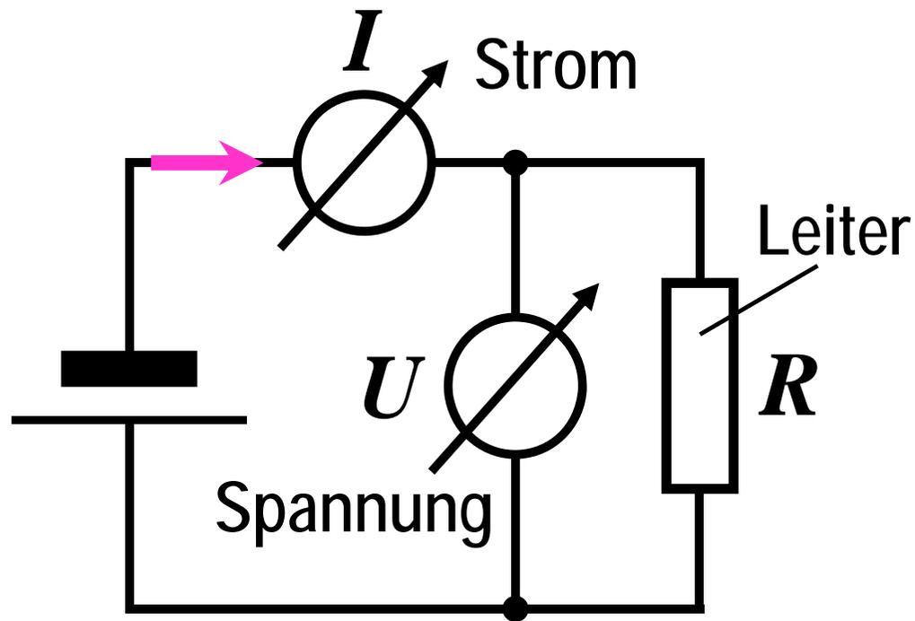
Der Widerstand wird durch die Messung der Spannung  $U$  und des Stroms  $I$  ermittelt. Bei der Strommessung liegt das Meßgerät in der Leitung („Durchflußmessung“), bei der Spannungsmessung parallel zu den Kontakten.
