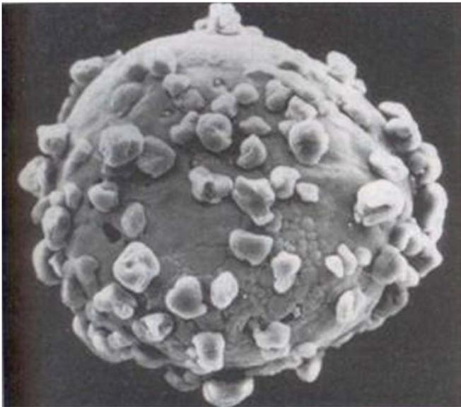
Elektronenmikroskopaufnahme von Tonerteilchen, die an einem größeren Teilchen „kleben“.
