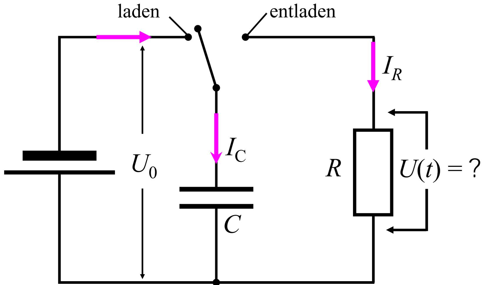
Zunächst wird der Kondensator über den Schalter mit der Batterie verbunden und lädt sich dabei auf die Spannung  $U_0$  auf. Danach wird auf den Widerstand  $R$  umgeschaltet, so daß über ihn der Strom  $I_R$  abfließt. Es soll der Spannungsverlauf  $U(t) = R I_R(t)$  berechnet werden.
