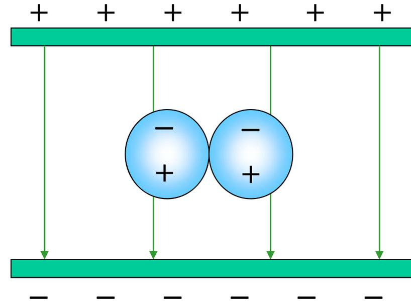
Wenn die Kugeln parallel zu den Platten ins Feld gebracht werden, dann werden die Ladungen auf jeder einzelnen aufgrund der Influenz verschoben. Nach der Trennung und dem Entfernen aus dem Feld gleichen sich die Ladungen aber wieder aus, und die Kugeln sind ungeladen.
