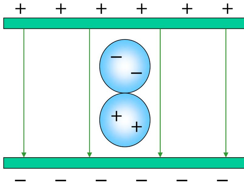
Nach der Trennung im Feld sind die Kugeln elektrisch geladen.
