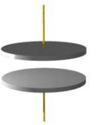
Beispiel : Der Plattenkondensator.
