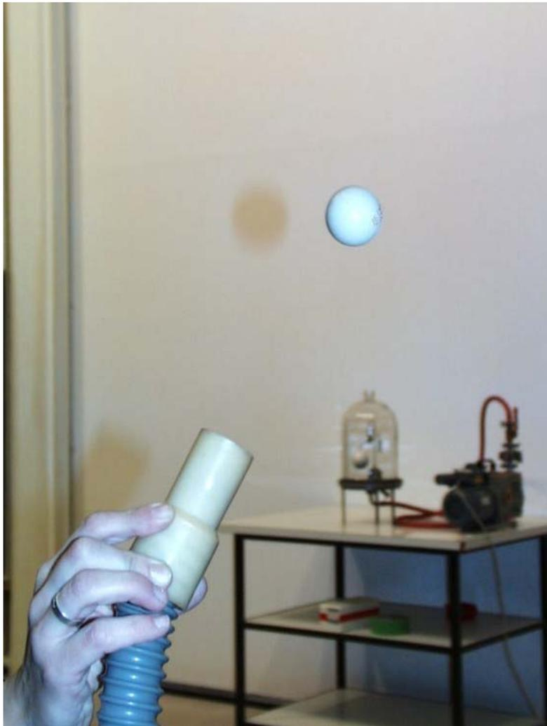
Der Luftstrom hält den Ball. Wenn er absinkt, strömt mehr Luft über den Ball, so dass hier der Druck abnimmt.
