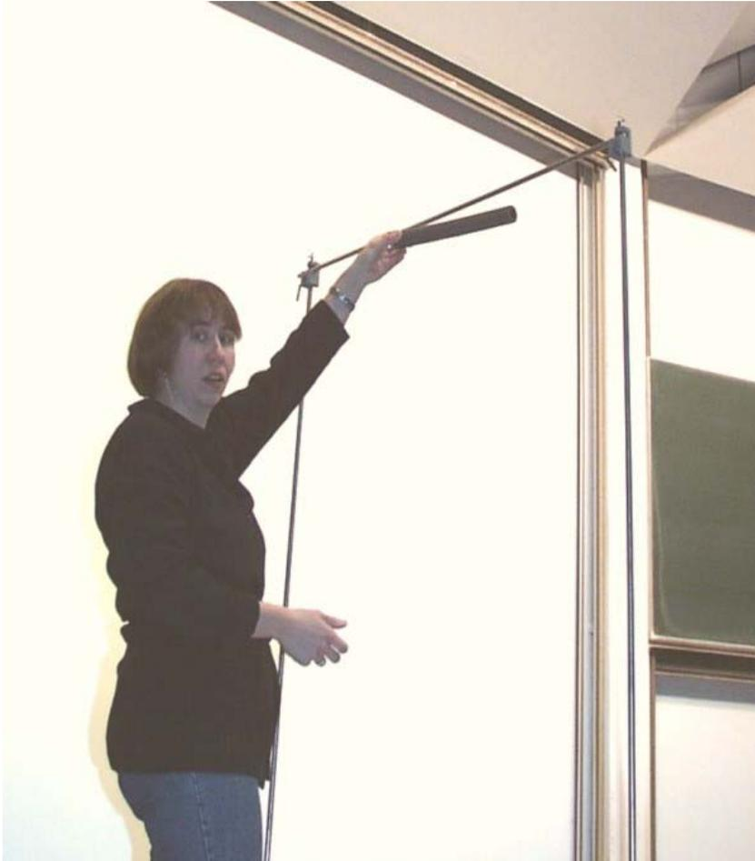
Um einen leichten runden Körper werden zwei Fäden gewickelt, an denen er hängt. Lässt man ihn los, wickeln sich die Fäden ab, und der Körper bewegt sich rotierend nach unten. Dabei entsteht eine ungleiche Druckverteilung.
