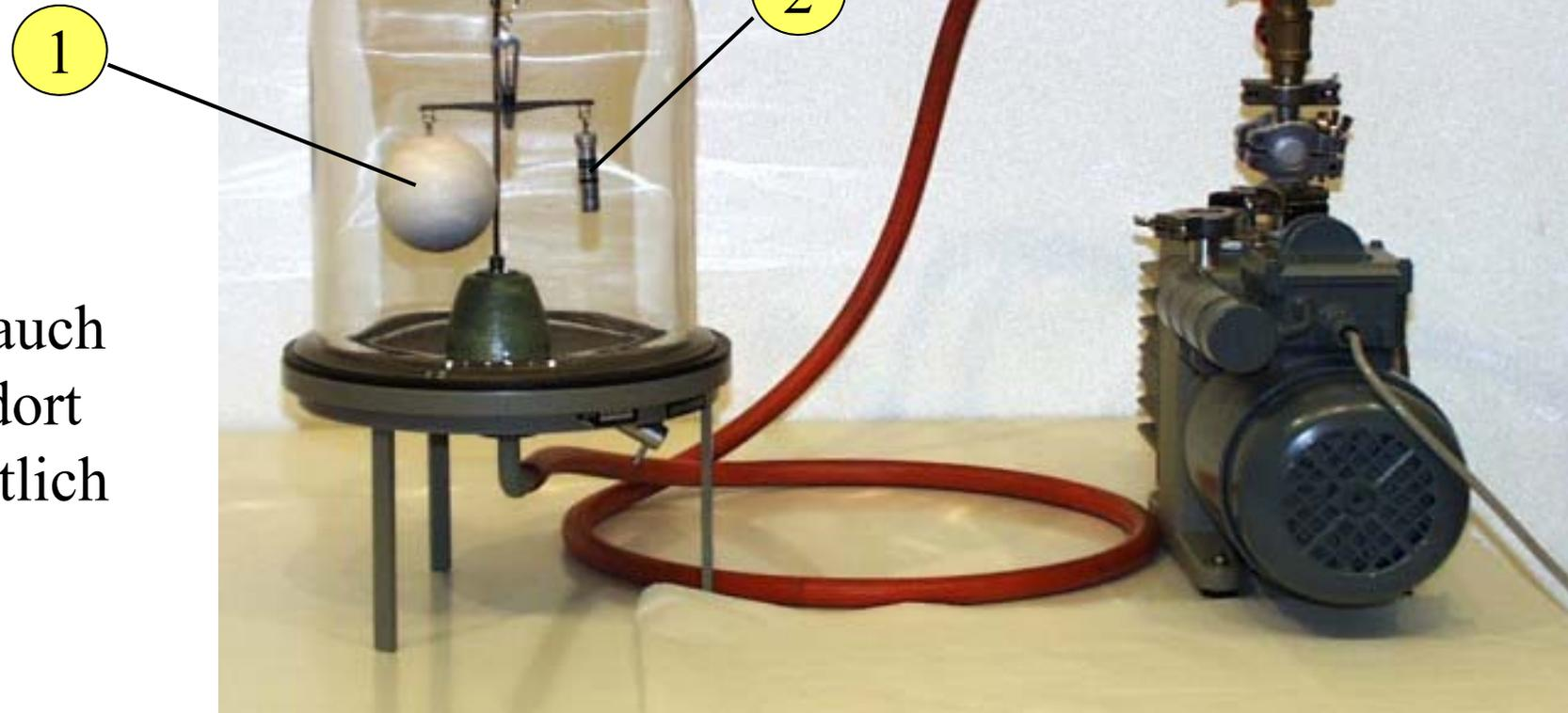
In Luft sind die große Styroporkugel (1) und der kleine Metallzylinder (2) im Gleichgewicht. Wegen des großen Volumens wirkt auf die Styroporkugel eine größere Auftriebskraft. Das Kräftegleichgewicht ergibt:
