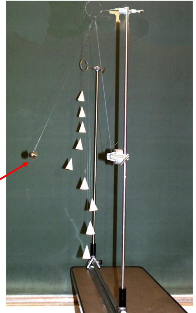
Pendel mit verschiedenen Fadenlängen und damit verschiedenen Frequenzen hängen an einem gemeinsamen Faden. Stößt man das Pendel mit der Stahlkugel an, werden die Pendel mit gleicher Fadenlänge, d.h. gleicher Frequenz, angeregt.
